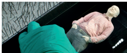
Nun wird das Alter-Ego von den Resten des Pulvers mit Pinsel und Druckluft gereinigt, wobei das überschüssige Material wieder in den Verarbeitungsprozess des Druckers zurückgeführt wird.
